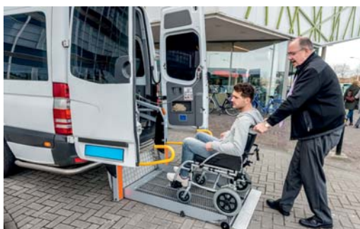
Fig. 49 Rampă pentru persoane cu nevoi speciale
