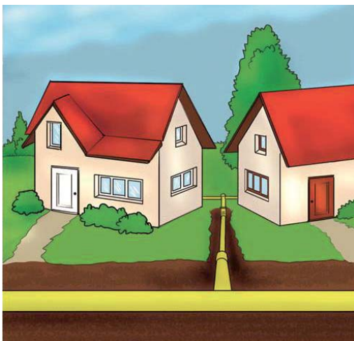
Fig. 14 Racordare la rețeaua de distribuție prin branșament
